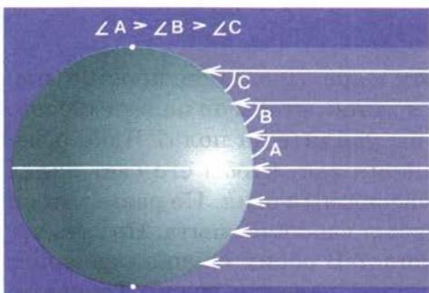
Рис. 42. Угол падения лучей на поверхность шара различен
